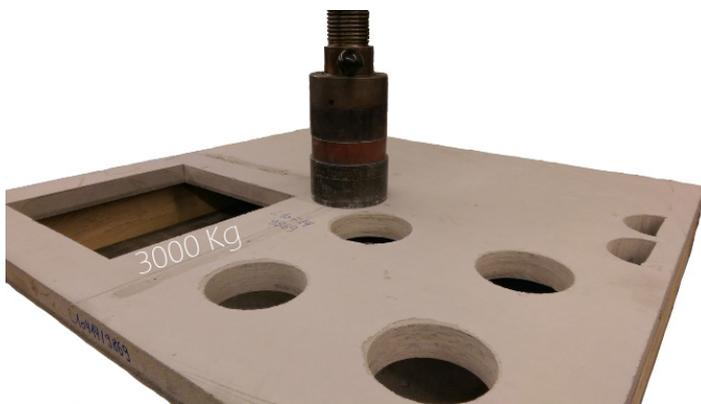
Die widerstandsfähige, faserverstärkte Plattenkonstruktion des AM FireShield® gewährleistet bereits in der Rohbauphase eine ausserordentliche Durchbruchssicherheit ohne aufwendige Abspermassnahmen.
